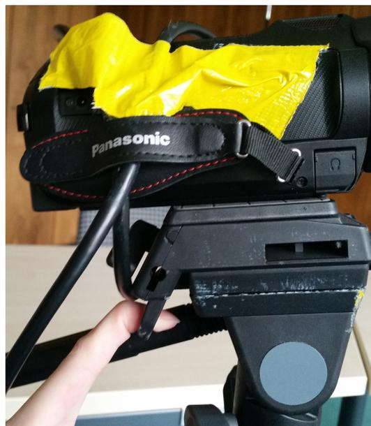
Verbinden sie den micro-HDMI Stecker des HDMI zu micro-HDMI Kabels mit der Kamera, den HDMI Stecker des Kabels mit dem HDMI Eingang des Galicasters. Schließen sie das Stromkabel der Kamera an die selbige an und stecken sie den Stecker des Stromkabels in die Steckdose.
