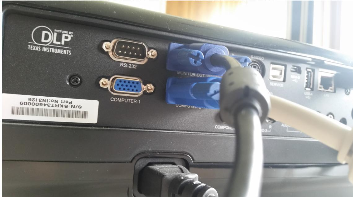
Verbinden sie den DVI Stecker des VGA zu DVI Kabels mit dem DVI Eingang des Galicasters.
